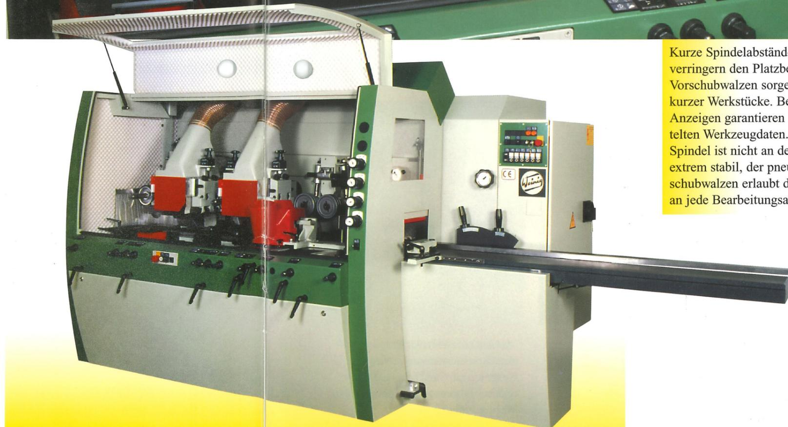
Kurze Spindelabstände halten die Maschine kompakt, verringern den Platzbedarf. Die kurzen Abstände der Vorschubwalzen sorgen für sicheren Transport auch kurzer Werkstücke. Bedienerfreundliche mechanische Anzeigen garantieren Einstellgenauigkeit der ermittelten Werkzeugdaten. Die Abführung nach oberer Spindel ist nicht an der Haube montiert und deshalb extrem stabil, der pneumatische Druck für die Vorschubwalzen erlaubt die Anpassung der Anpresskraft an jede Bearbeitungsaufgabe.
